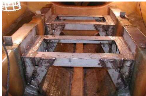
FRP 船に対し、鉄架台を設置した例
