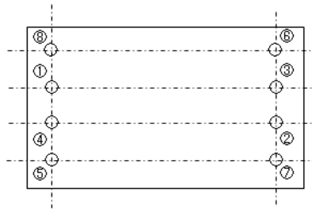
図 4-6 ボルトの締付順序 (例)
